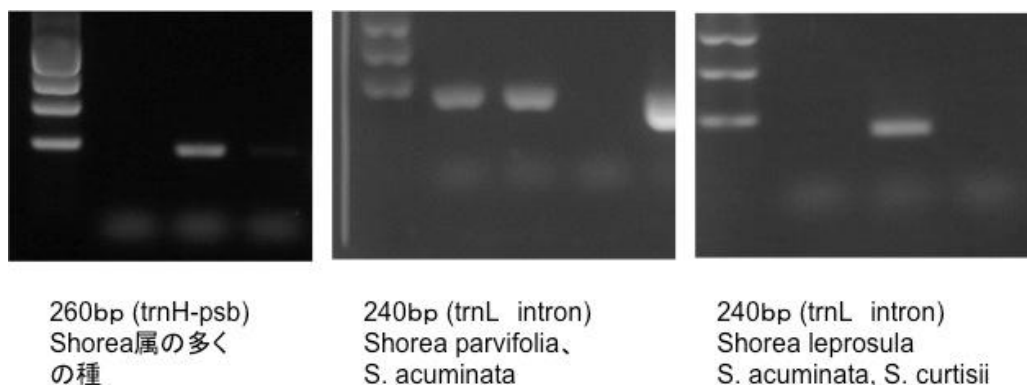
図 5 乾燥した単板および合板からの DNA 検出の成功例
