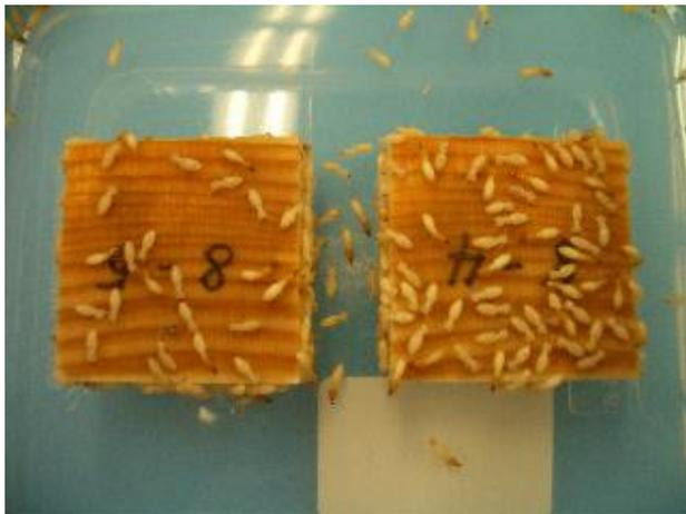
図 3-2 シトロネラル処理 60s 後の試験片上のイエシロアリの様子
