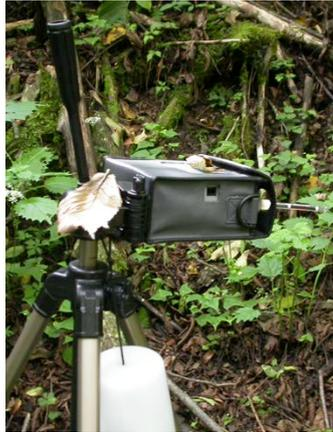
写真 2-3 物理指標の測定に用いた PMV 測定器 (左) とフィトンチッドの採取に用いた吸着管付き小型ポンプ (右)
