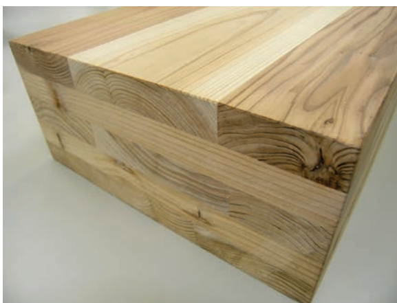
図3 ひき板を直交積層しているCLT
