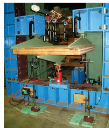
図4 強度試験機で曲げ性能を測定
