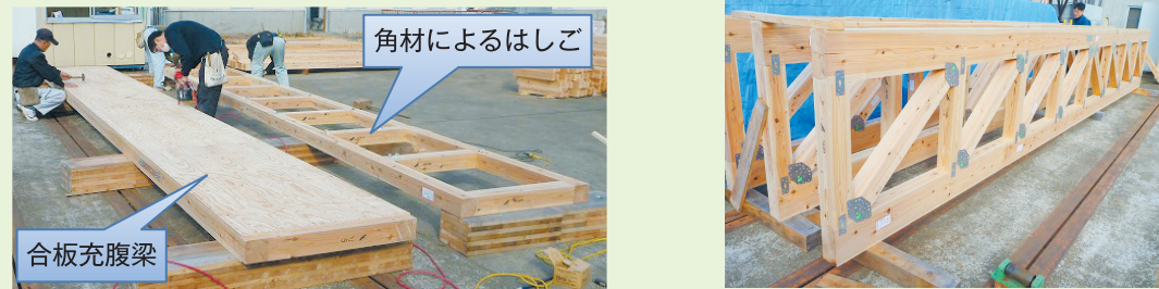
図1 選定した梁のうち、合板充腹梁(左)および製材トラス梁(右)の概要 合板充腹梁:角材によるはしごの両面に合板を釘で留めた梁、製材トラス梁:製材の角材のみで構成される梁
