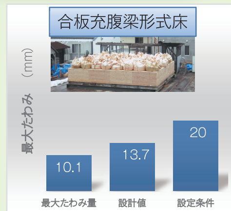
図2 砂利袋を床全面に載せたときの実大床の最大たわみ量・設計値・設定条件
