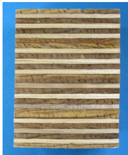
図1 促進劣化処理 (煮沸—乾燥)後の 超厚合板接着試験片 の外観
