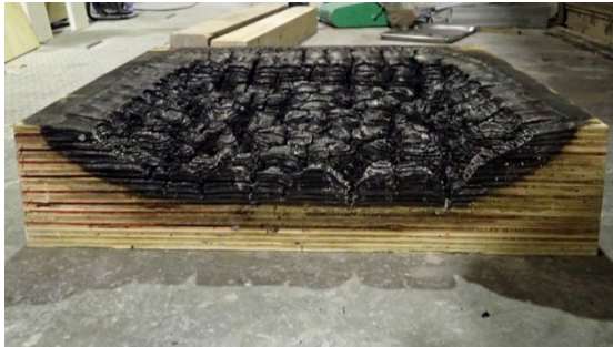
図4 加熱試験(144分)後の炭化の様子 試験体: 無被覆超厚合板: (650×600×144mm) 加熱終了後すぐに脱炉・消火したもの。
