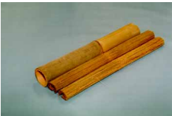
写真2. 竹を押しつぶして作ったゼファー 割裂性が高く、繊維束が長いので、均一な網目状に加工できる。
