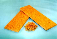
写真1. 竹のパーティクルボード 木材を用いた場合と同程度の性能が得られる
