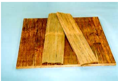
写真3. 竹のゼファーボード 木材から作ったボードより、強度・寸法安定性に優れている。
