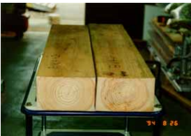
写真 高周波加熱減圧法による大断面材の乾燥
