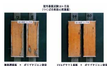
写真1：屋外暴露試験による透明塗膜の劣化；左-無処理単板+ポリブタジエン塗装、右-UVAのグラフト単板+ポリブタジエン塗装；屋外暴露試験18か月後・つくば市・南面45度暴露
