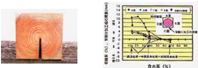
写真1. 背割り加工柱材の断面 図3. 人工乾燥中のスギ柱材の寸法変化
