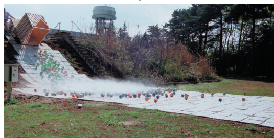
写真1 花崗岩ブロックによる崩壊実験の様子
