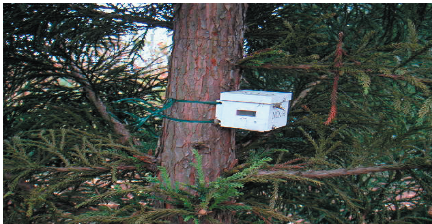
写真2 樹幹動揺計の設置例
