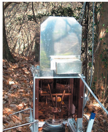
写真2 土壌呼吸チャンバー (土から出入りするCO 2 を直接測定)
