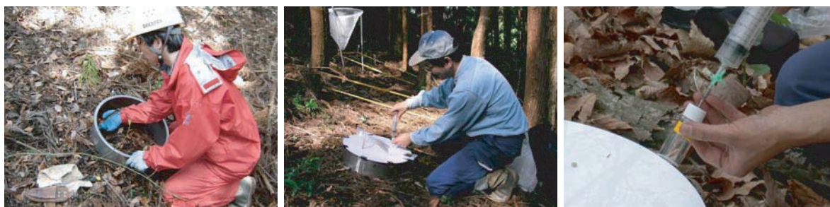
図1 現地での温室効果ガスの放出・吸収量の測定作業 (チャンバーの設置(左)、ガス採取(中央)、採取ガスの封入(右))
