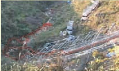
現地崩壊実験による流出土砂の到達範囲の実証をしました。
