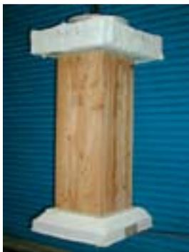
写真1 耐火試験用の試験体
