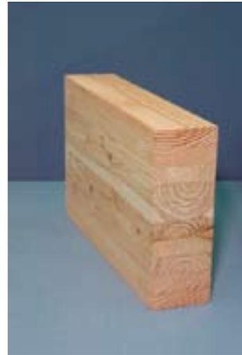
図1 集成材のラミナ構成（異樹種集成材の一例）
