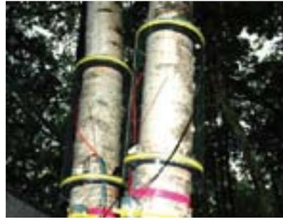
図3b 幹呼吸の測定
