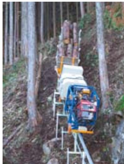
写真2 運搬車両による端材の運搬
