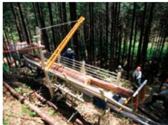
写真4 積込装置による間伐材の運搬車両への積み込み
