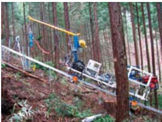
写真3 敷設装置と簡易レール
