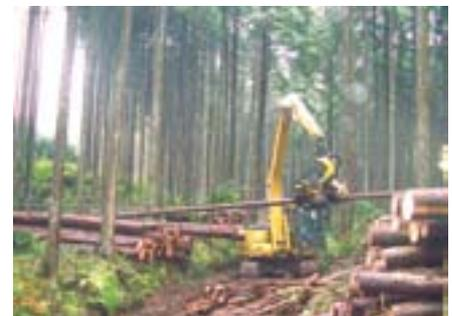
写真2 高性能林業機械による間伐材造材作業
