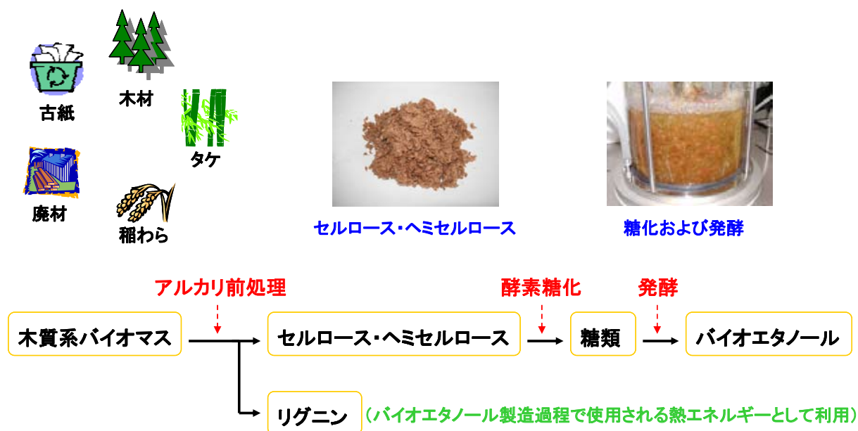
図1 アルカリ前処理と酵素糖化を用いたバイオエタノール生産プロセス
