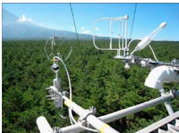
図3 森林総合研究所富士吉田試験地における、ポータブルフラックス測定システム（左）を用いた比較観測の様子（右側の測器は経常システムの超音波風速計など）
