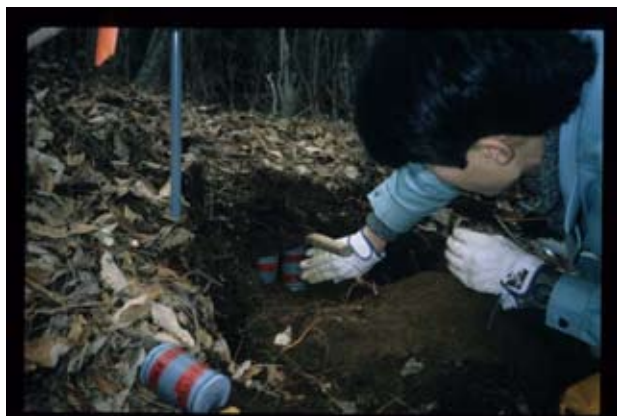
写真 採取した土壌円筒をその場の土壌断面内に埋め戻す様子(左)と埋設後に掘り出した土壌円筒(右)
