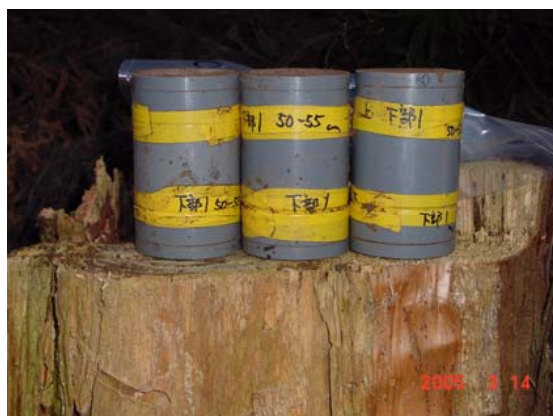
写真 採取した土壌円筒をその場の土壌断面内に埋め戻す様子(左)と埋設後に掘り出した土壌円筒(右)
