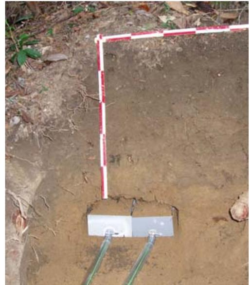
図2 採水装置とその設置状況
