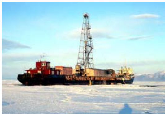
写真1 バイカル湖の湖底堆積物を採取するための掘削船
