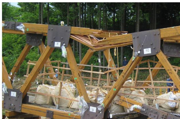
写真5 下流側上弦材の圧壊 (最終破壊)
