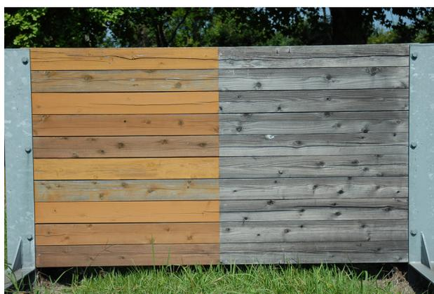
写真5 木材保護塗料による遮音壁の美観維持効果 (屋外暴露4年後) (左半分が5種類の木材保護塗料による塗装処理、右半分は無塗装)
