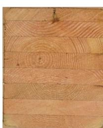
写真6 部材の断面内含水率分布と切断面
