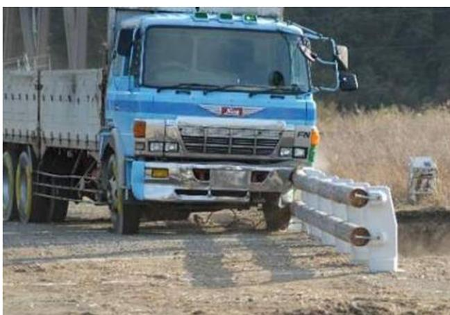
写真3 10年経過した木製防護柵の大型貨物車による実車衝突確認試験 (目視劣化度が1~2程度ならば十分な衝突抵抗性能を維持しています)
