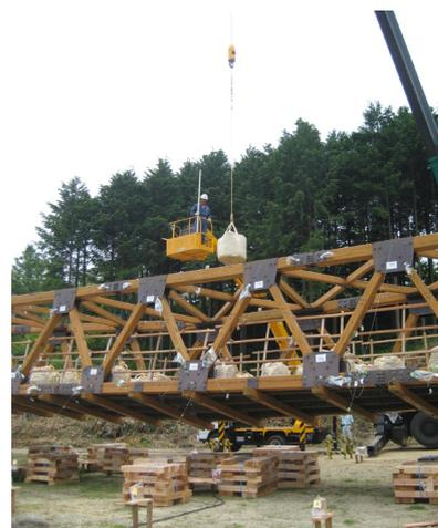
写真3 クレーンで土嚢を載せる
