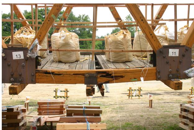
写真4 上流側下弦材の破断 (最初の破壊)
