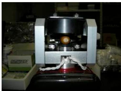
図3 ドングリ測定用携帯型近赤外分光器 (NIR-GUN) 右図は測定の様子 (アタッチメント部にドングリが挟まれている)
