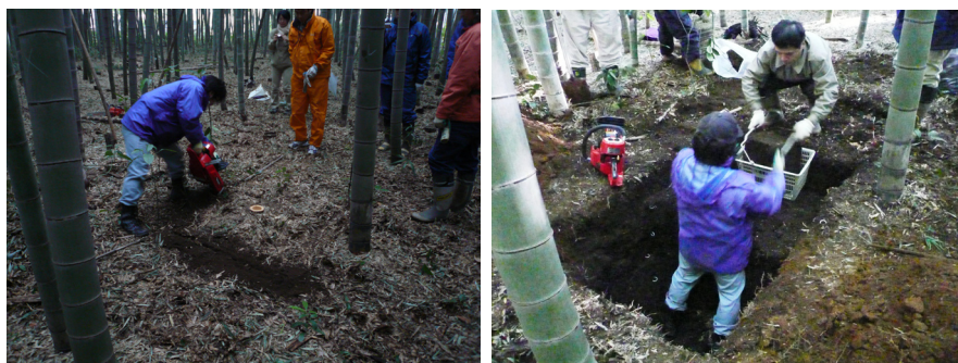
図3 地下部バイオマス調査 根切りチェーンソーを使い、土ごと さいの目に切って地下部を掘り 出す。
