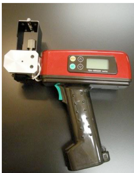
図3 ドングリ測定用携帯型近赤外分光器（NIR-GUN） 右図は測定の様子（アタッチメント部にドングリが挟まれている）
