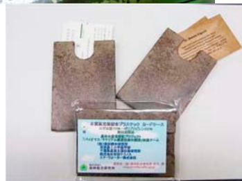
図3 射出成型による木質高充填複合材の製造 (ノズルから射出しているコンパウンド (左上) と型枠 (左下)、連続射出成型によ生産されたカードケース (右上下))
