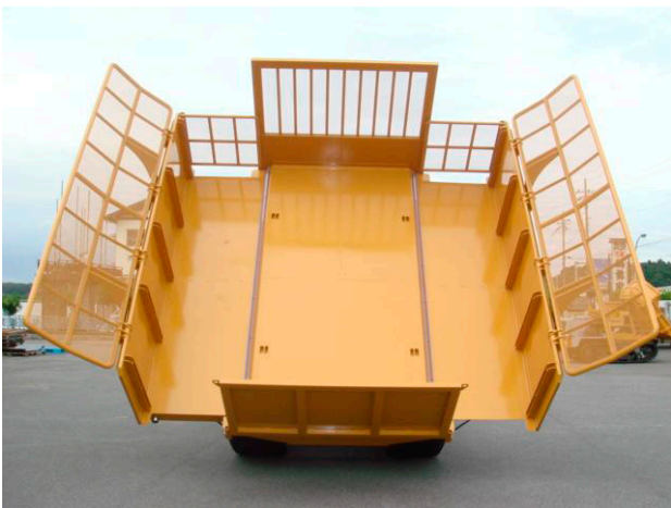
写真3 バイオマス対応型フォワーダ 林業バイオマスを荷台フレームで圧縮できる
