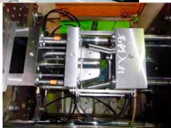
図3 射出成型による木質高充填複合材の製造 (ノズルから射出しているコンパウンド (左上) と型枠 (左下)、連続射出成型によ生産されたカードケース (右上下))
