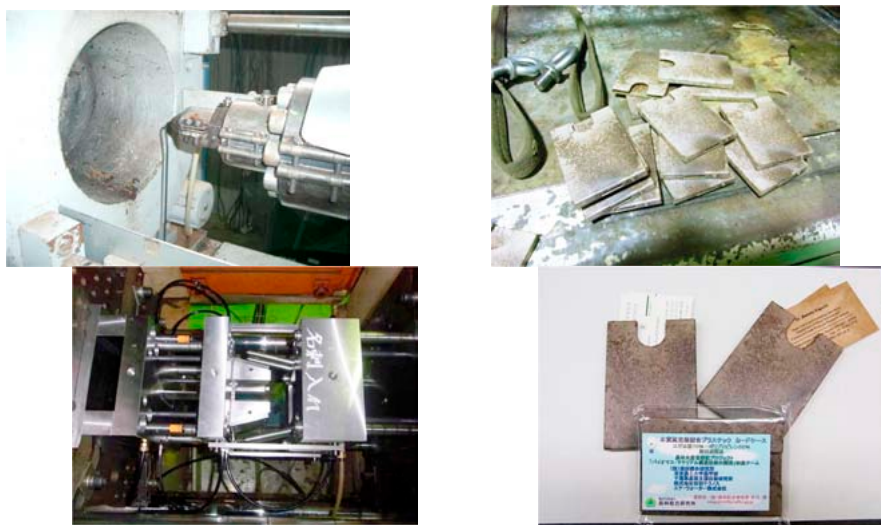
図3 射出成型による木質高充填複合材の製造
