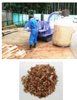
図1 木質バイオマスを用いた木質高充填プラスチック複合材の製造
