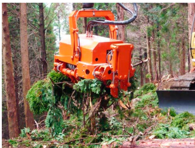
写真2 枝葉の破碎作業 チッパー機能により枝葉を粗破碎している
