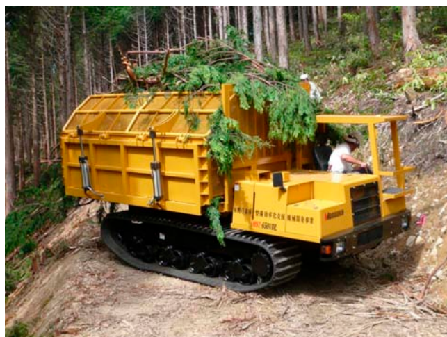
写真4 林業バイオマスの圧縮運搬作業
