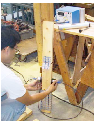
非破壊試験 超音波伝播時間測定
