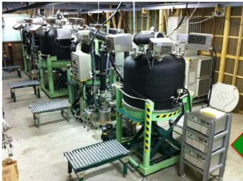
図3 減圧式マイクロ波水蒸気蒸留装置による経済的な大量抽出
