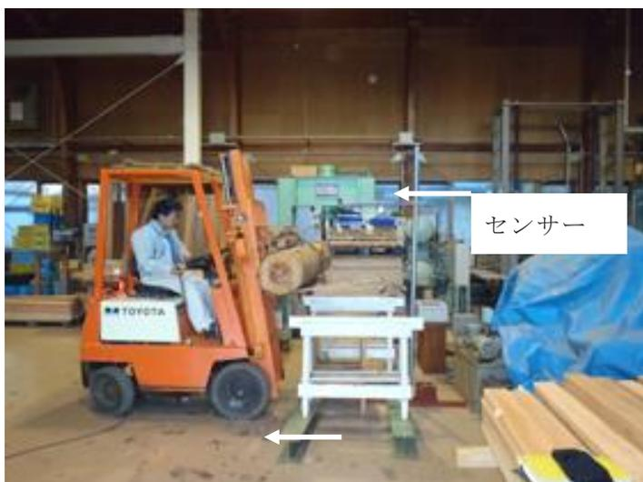
図3 電磁波による水分量測定の様子
