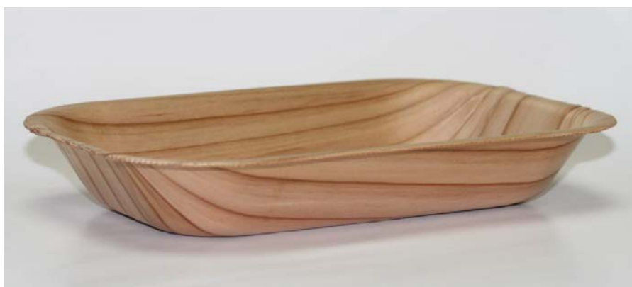
写真2 深形木製単層トレイ (曲げ角度 60°、深さ 30mm)
