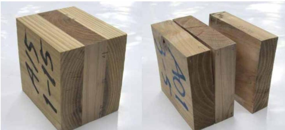
図3 剥離試験による接着不良の検出
