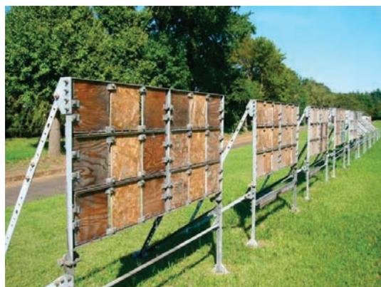
図2 屋外暴露試験
