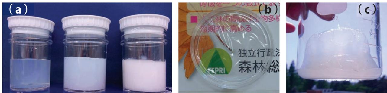
図3 酵素処理と機械処理を併用して得られたタケセルロースナノファイバー
