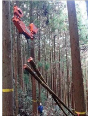
図2 木を吊り上げる搬器
