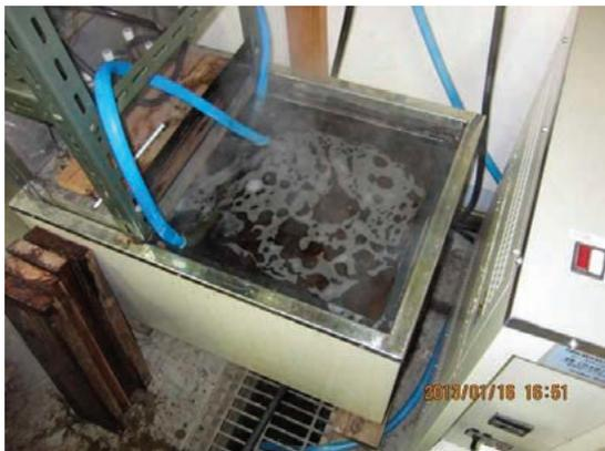
図1 温水浸せき試験
