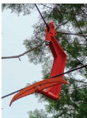
図4 中間支持金具 架線を持ち上げる金具
