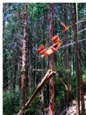
図3 中間サポートを通過する搬器
