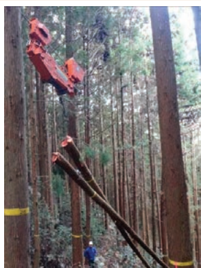
図2 木を吊り上げる搬器
