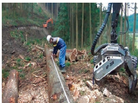
図2 大径材の造材作業
