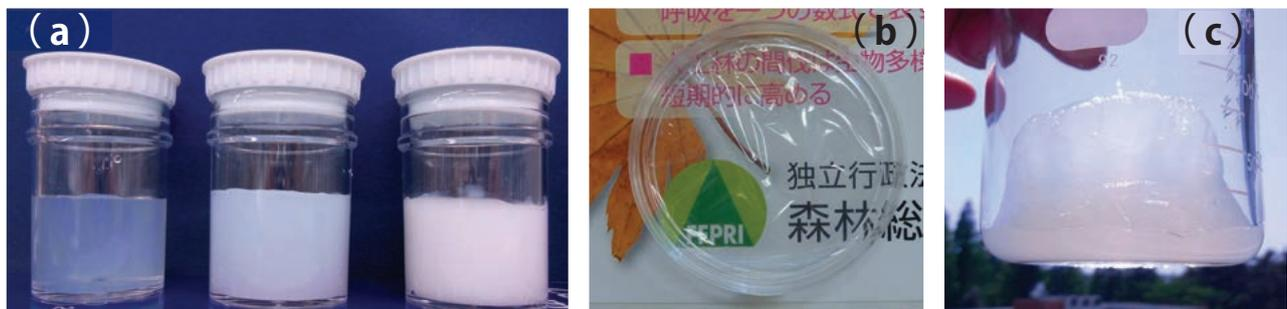
図3 酵素処理と機械処理を併用して得られたタケセルロースナノファイバー
