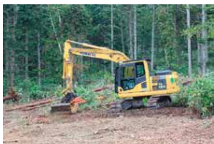
図3 クラッシャによる地拵え作業
