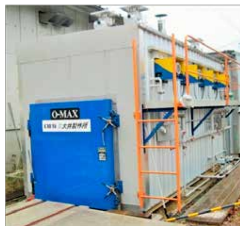
図2 箱形の減圧乾燥装置 (株) 大井製作所：OHV4-1HSV 型
