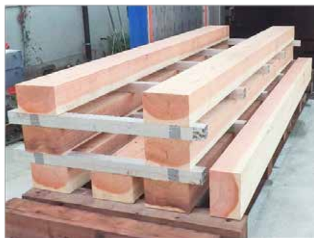
図4 乾燥試験に用いたスギ平角材 寸法：断面 180 × 135 mm、長さ 3050 mm
