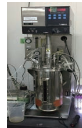
図2 孢子を大量に生産するジャー培養装置
