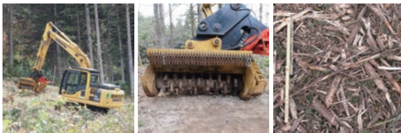
図1. エクスカベータに装着したクラッシャと、クラッシャ地ごしらえで堆積する破砕物
