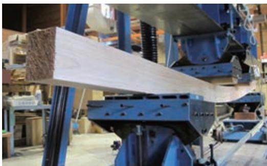
図3. 平角材の曲げ強度試験
