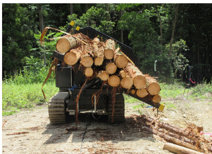
図3. 自動荷おろし作業中のフォワーダ
