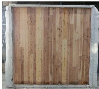
試験後の内部CLT表面の様子
