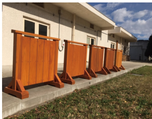
図4. CNF配合塗料を下塗りに用いて 塗装した木製フェンス
