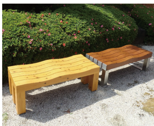
図3. CNF配合塗料を下塗りに用いて 塗装した木製ベンチ
