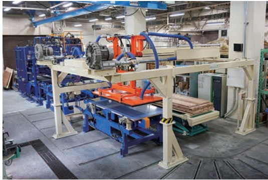
写真1 小型CLT試作機 (森林総合研究所内)
