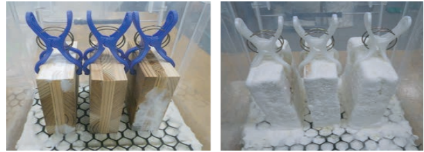
写真2 CLTへの保存処理技術の開発 強制腐朽させたCLTの様子 (左：保存処理、右：無処理)
