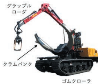
図1 ゴムクローラ式クラムバンクスキッドとそれを用いた全木集材作業
