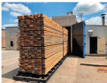
図3 実大型弱減圧乾燥装置
