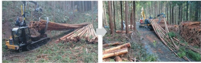
図1 ゴムクローラ式クラムバンクスキッドとそれを用いた全木集材作業
