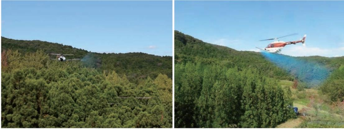
図1 無人ヘリコプター(左)と有人ヘリコプター(右)によるスギ花粉飛散防止剤の空中散布
