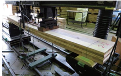
図3 フィンガー長さ6mmのマイクロフィンガージョイントでたて継ぎし
