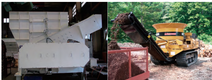
図2 使用した工場定置型破碎機(左)と現地移動型破碎機(右)
